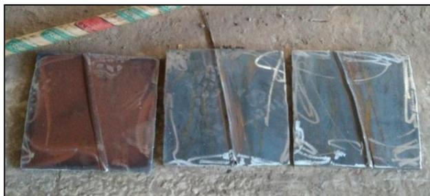
As amostras foram identificadas com as siglas V1, V2 e V3 que fazem referência as velocidades adotadas em cada uma das soldagens realizadas, sendo as mesmas 800 mm/min, 1200 mm/min e 1600 mm/min respectivamente.
