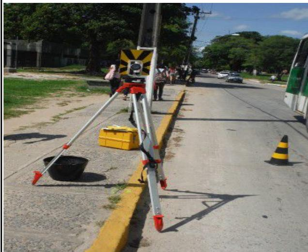
Vértice L1 ocupado com tripé e prisma com centragem forçada.
