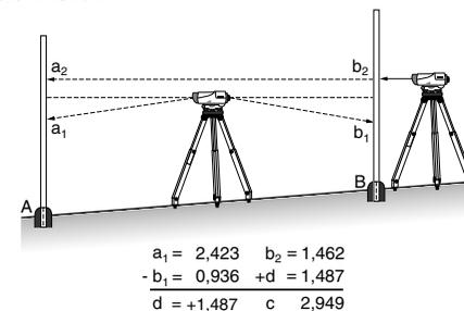
1. Instale el instrumento a media distancia entre dos puntos (A y B) separados entre 30 y 40 m.
