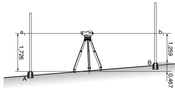
1. Instale el instrumento a media distancia entre dos puntos (A y B).
