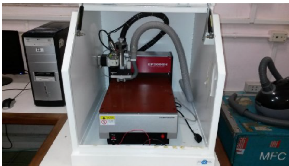
Figura 30 – Fresa CNC para fabricação de placas de circuito impresso
