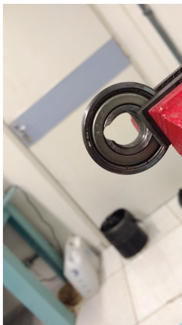
Figura 36 – Rolamento danificado trilha interna
