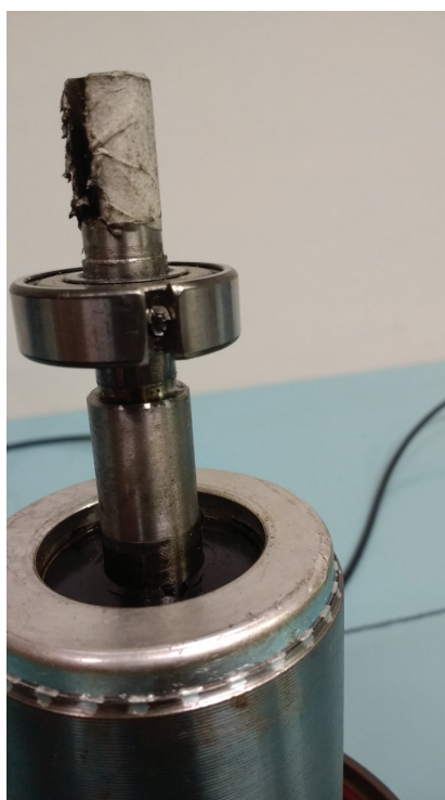
Figura 37 – Rolamento danificado trilha externa
