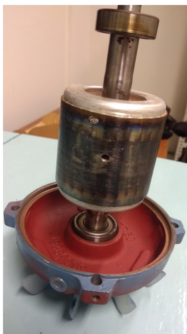
Figura 35 – Rotor 2, barras também danificadas através de processo de furação.
