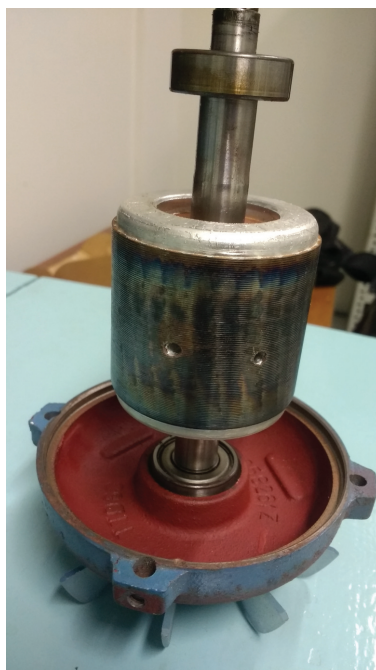
Figura 34 – Rotor 1 com suas barras danificadas através de furação
