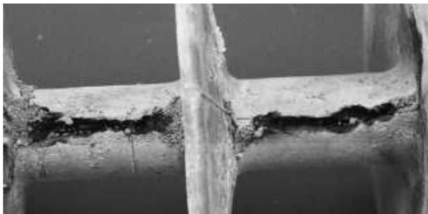
**Figura 4** – Danos formados em isoladores poliméricos causados por descargas parciais (foto extraída de [5]).
