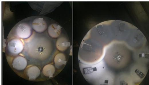
**Figura 20**– Em (a) mostra-se a suporte antes da deposição e em (b) tem-se a suporte após deposição em que pode se visto o zinco espalhado ao redor das amostras.
