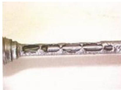
**Figura 6** – Sensor de resistência linear após desgaste [3].
