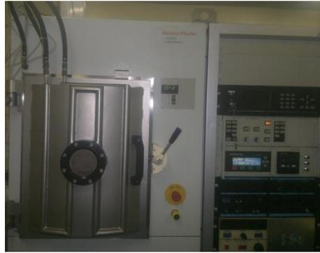
**Figura 15**– Foto do equipamento de sputtering utilizado na deposição.
