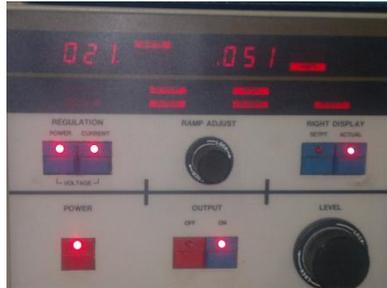
**Figura 19**– Equipamento de medição da corrente de formação do plasma.
