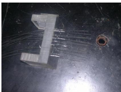
**Figura 12**– Suporte para apoiar até 20 fibras ópticas.
