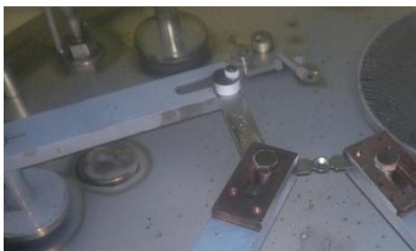
**Figura 13**– Eletrodos utilizados para realizar a deposição térmica.
