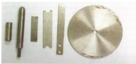
**Figura 4** – Vários tipos cupons de prova [3].
