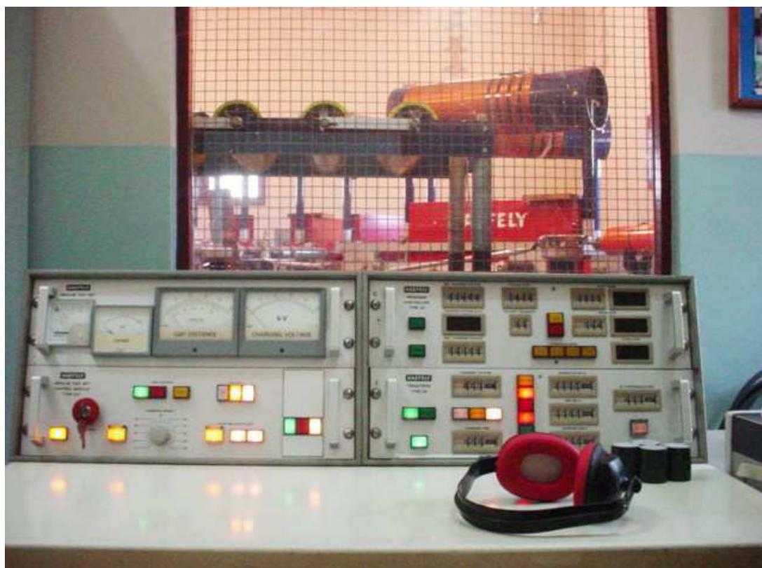
**Fig. 82 – Fotografia da mesa de controle do circuito gerador de impulsos de corrente pertencente ao Laboratório de Alta Tensão, UFCG [31].**
