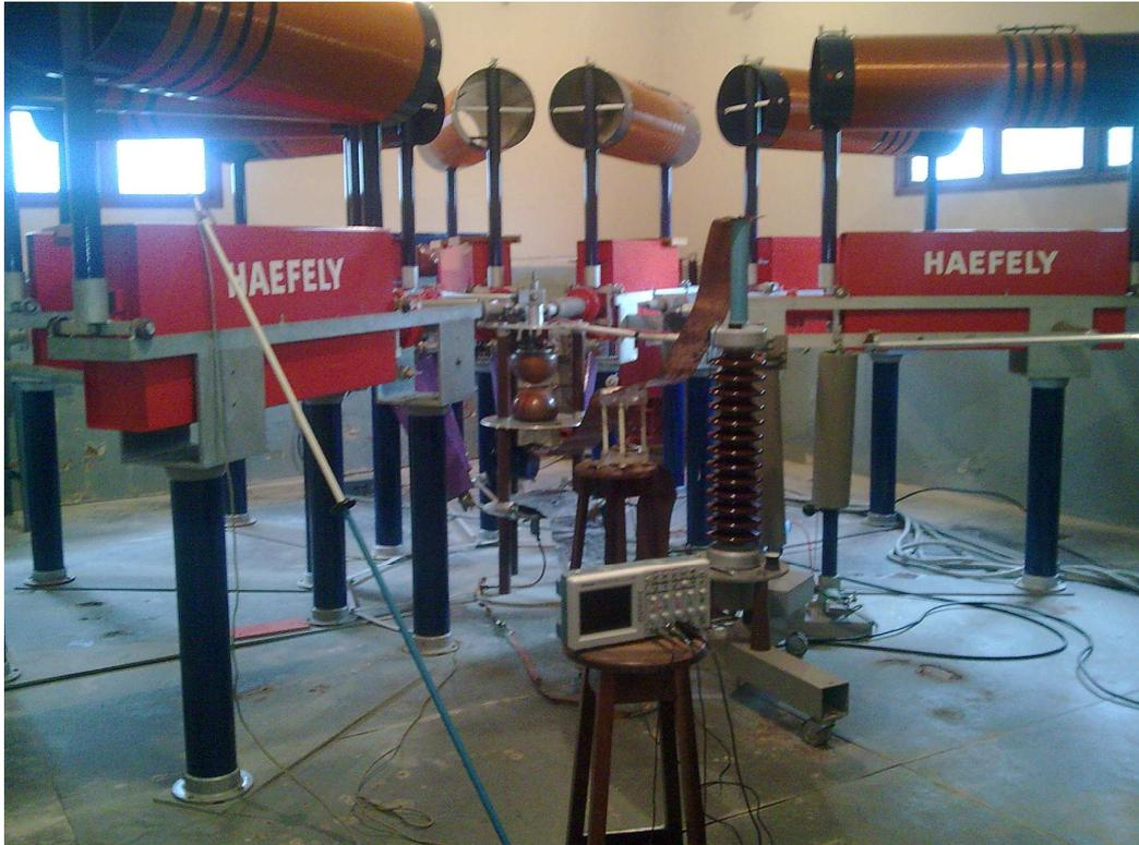
Fig. 39 – Fotografia do circuito gerador de impulsos de corrente, Laboratório de Alta Tensão, UFCG.
