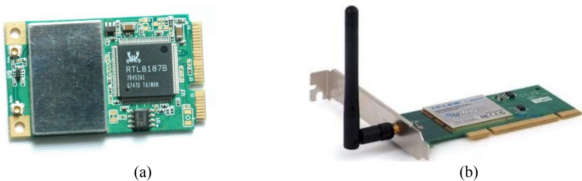
Figura 1.3 - (a) Placa para comunicação WiFi com chip RTL8187, sem antena, com 48x30mm, e interface USB. (b) Placa TP-Link TL-WN353GD, com antena, interface PCI.
