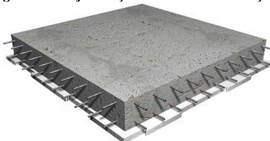
Figura 22 – Laje maciça armada em duas direções.
