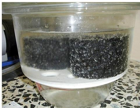
b) Saturação dos Corpos de Prova
