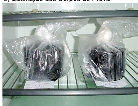
(d) CP condicionados à temperatura de  $-18^{\circ}\text{C}$
