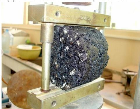
(f) Realização da RT a  $25^{\circ}\text{C}$  após condicionamento
