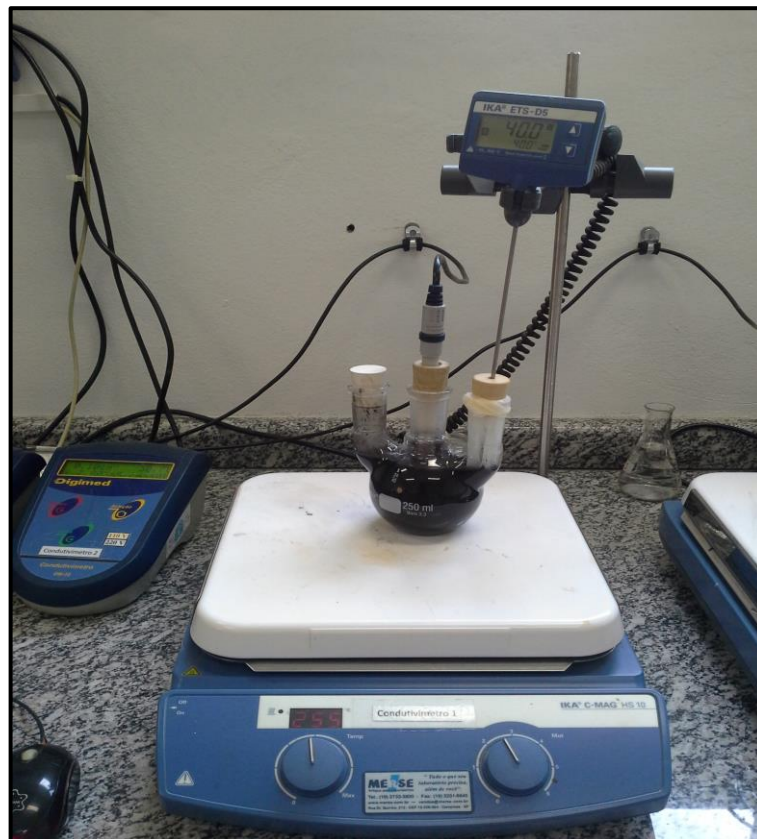
Figura 3.11 – Ensaio de atividade pozolânica pelo método de condutividade elétrica do sistema CH/cinza.
