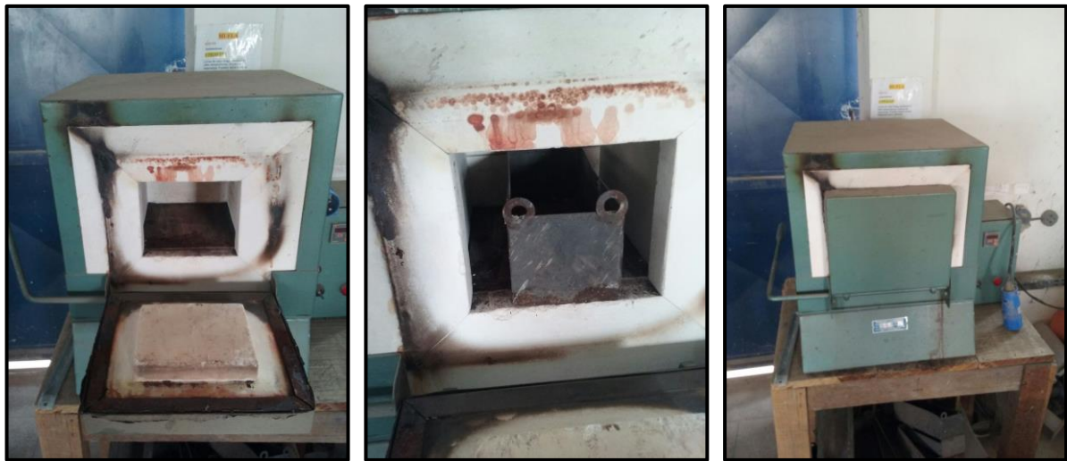
Figura 3.6 – Procedimento de queima das CBCA em mufla.
