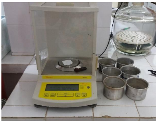
Foto 8: Pesagem do papel filtro após secagem na estufa.
