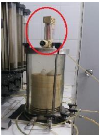
Foto 4: Câmara de fluxo com rotâmetro
