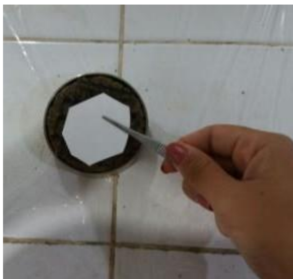
Foto 6: Posicionamento do papel filtro no anel
