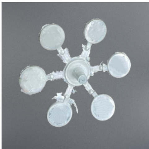
Figura 1 – Estrutura de árvore das peças de Zamac produzidas.
