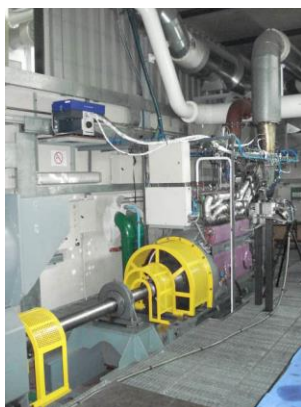
Figura 3 - Motor MAN B&W Holeby L16/24 de 440 kW
