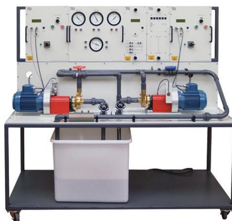
Figura 41 – Bancada didática para ensaios de bombas
