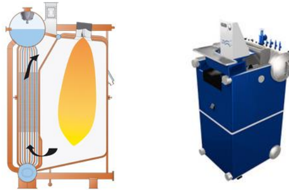
Figura 14 – Caldeira aquotubular da Alfa Laval
