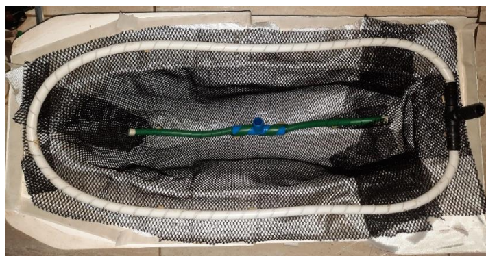
Figura 61 - Colocando os consumíveis.
