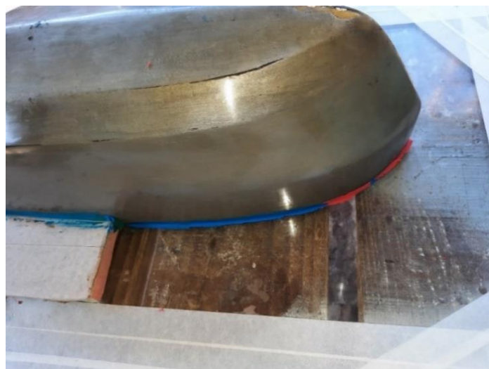
Figura 48 - Aplicação da massa de modelar.
