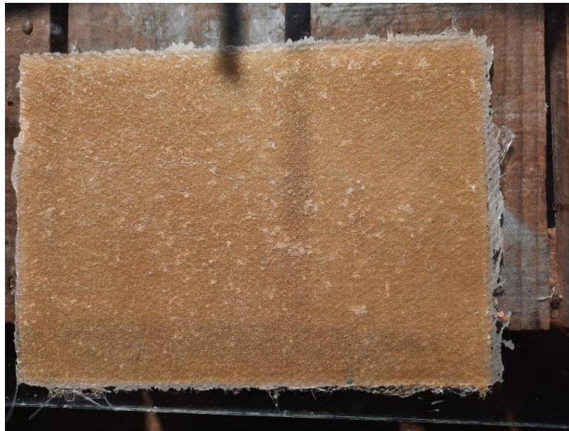
Figura 59 - Resultado da infusão da placa.
