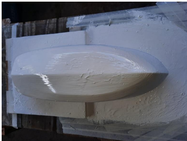
Figura 50 - Aplicação do gel-coat.
