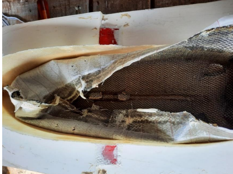
Figura 66 - Retirando o peel ply e a malha de infusão.
