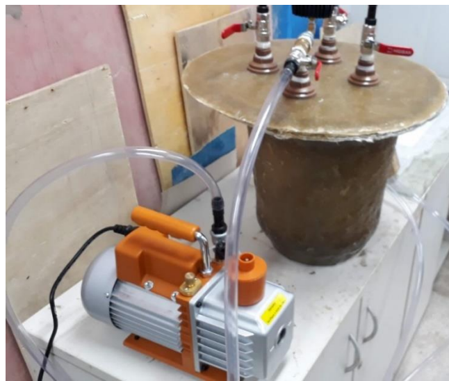
Figura 32 - Equipamentos principais para a laminação a vácuo e a infusão a vácuo.
