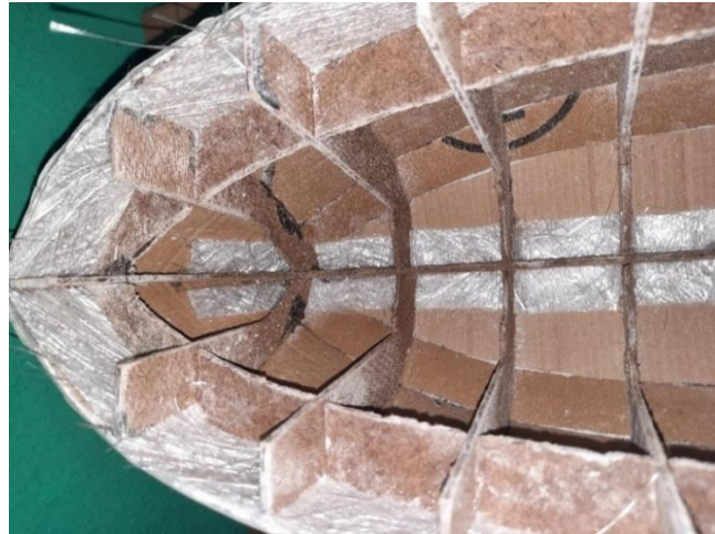
Figura 43 - Imagem da fibra aplicada na parte interna.
