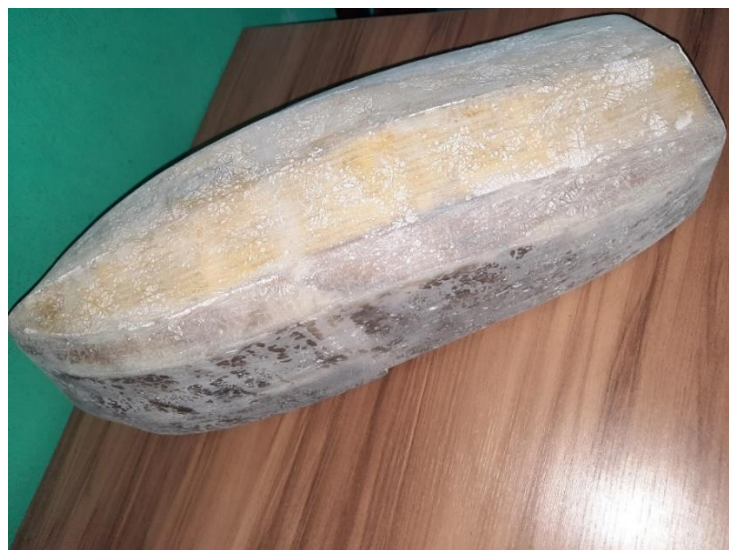
Figura 42 - Imagem do casco com fibra de vidro.
