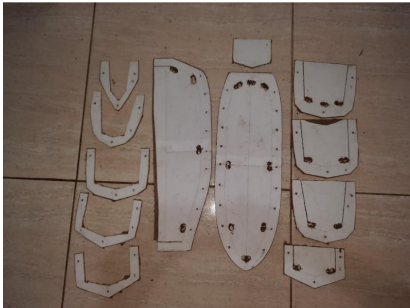
Figura 38 - Furos para facilitar os cortes.
