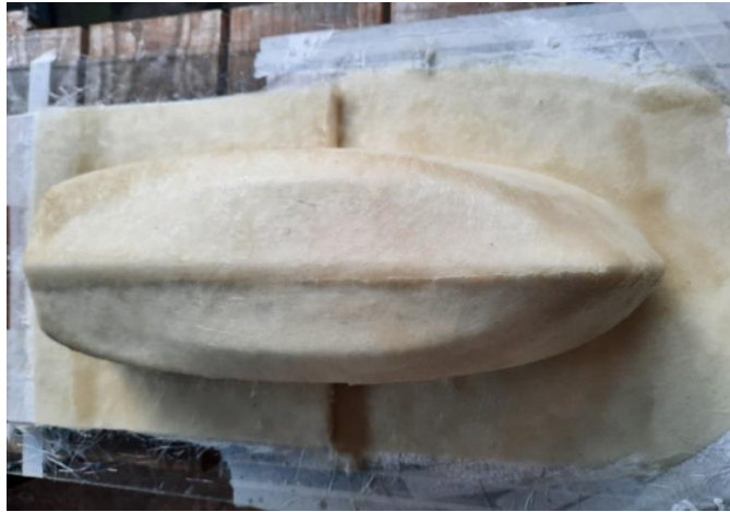
Figura 51 - Fibra de vidro aplicada.
