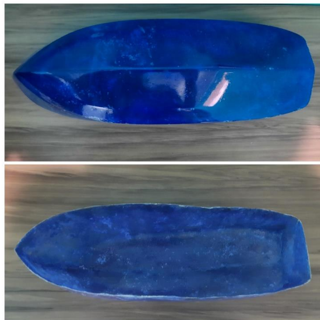
Figura 76 - Resultado da laminação a vácuo.
