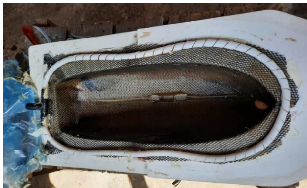
Figura 65 - Laminado prestes a ser desmoldado.
