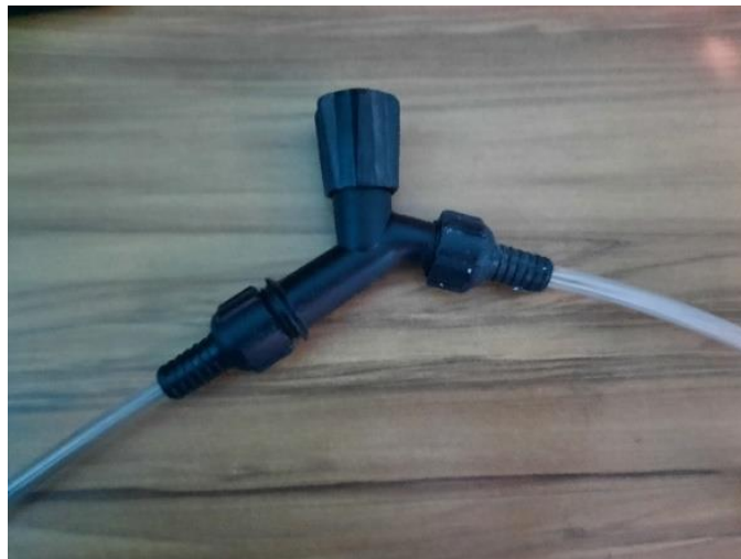
Figura 24 - Adaptação na entrada de resina
