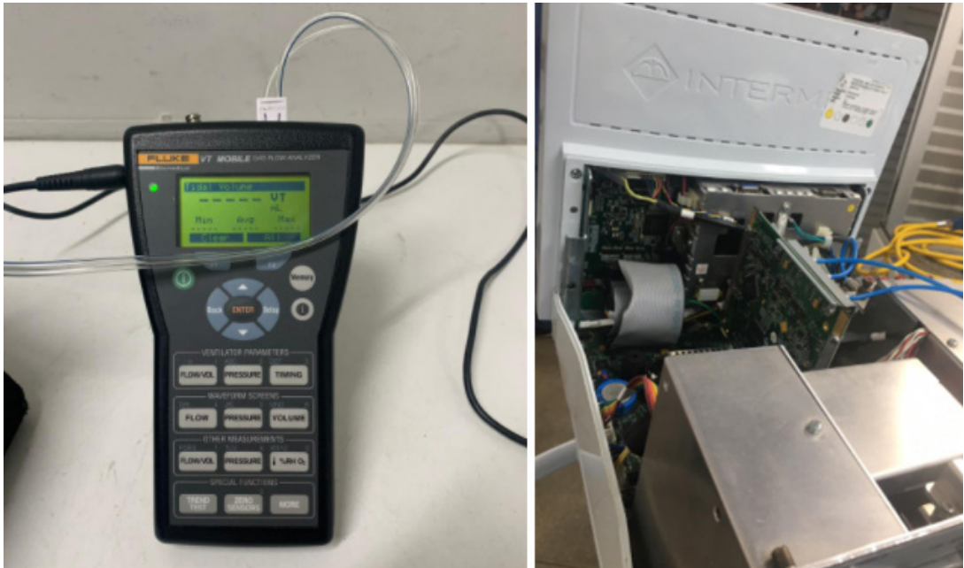
Figura 4 – Calibração e manutenção preventiva e corretiva de ventiladores mecânicos invasivos
