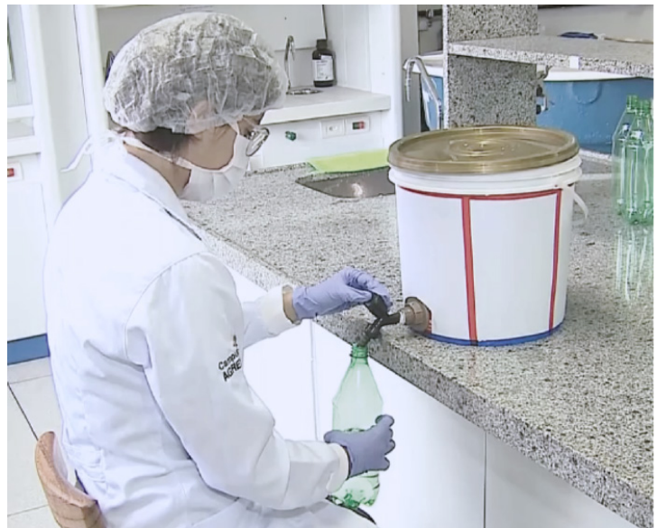
Figura 2 – Exemplo de barriletes de laboratório construído pelos alunos
