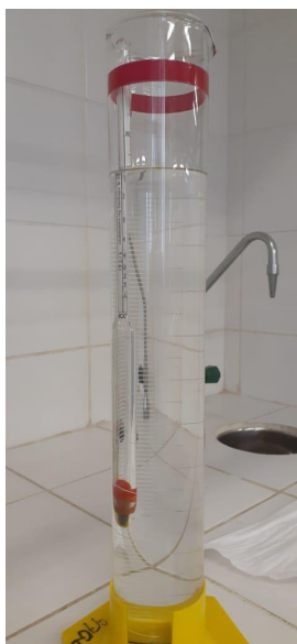
Figura 6 - Certificação do grau alcoólico da matéria-prima e das soluções alcoólicas produzidas
