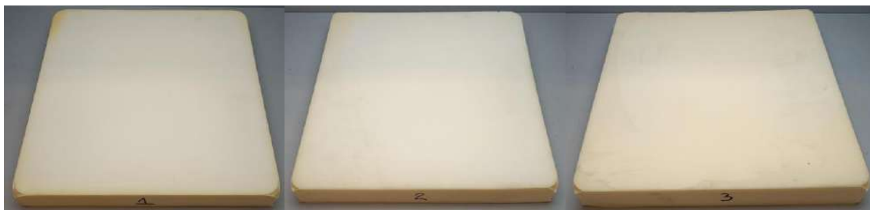
Figura 1: Corpos de prova para o ensaio de força de indentação.
