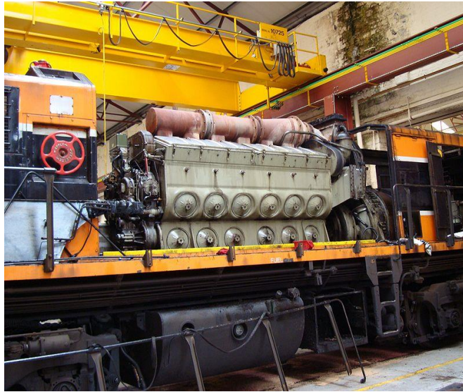
Figura 4 - Motor de locomotiva, EMD 12-645E3, média rotação
