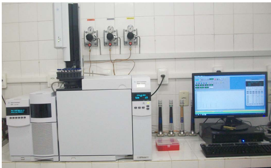
Figura 5. Cromatógrafo a gás acoplado a um espectrômetro de massas (GC-MS).
