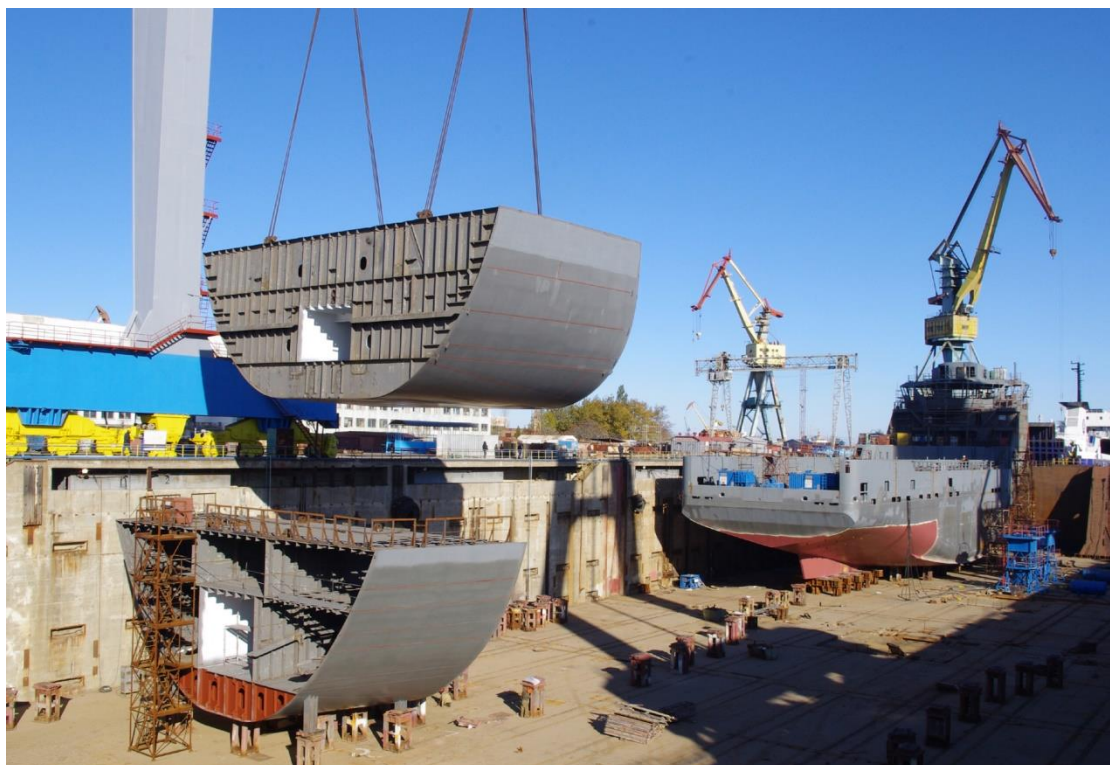
Figura 2 - Suspensão de um megabloco no Estaleiro Zaliv (Fonte: Offshor Energy Today).
