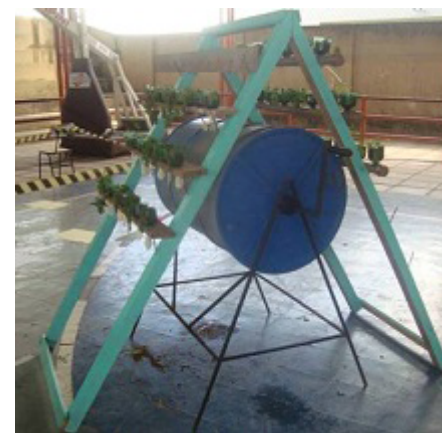
Figura 7. Sistema combinado de produção de hortaliças por hidroponia de pavo e compostagem em tonel suspenso rolante.
